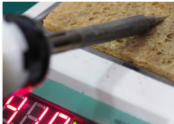
(1) Pulire la punta del saldatore su una spugna bagnata.
